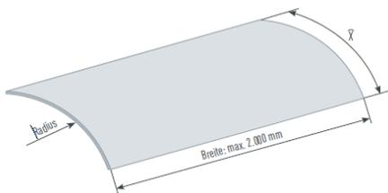
Bedingt durch das Formen mit Walzen haben die Platten am Anfang und am Auslauf der Rundung eine Druckstelle, die durch PREFA zurückgeschnitten wird. Damit diese Druckstellen weggeschnitten werden können, müssen zum fertigen Bogenmaß 200 mm addiert werden. Diese Materialzugabe
